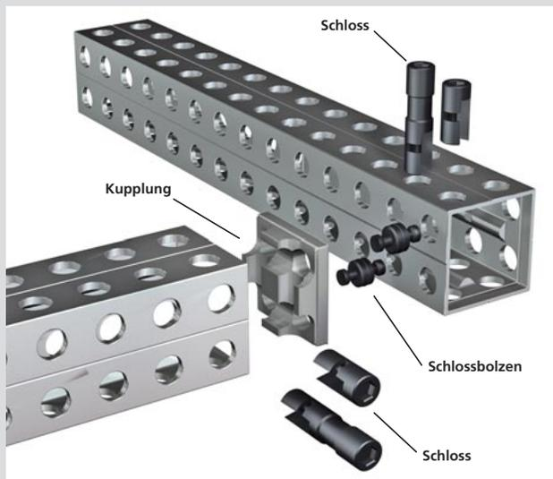
**Einfache Kupplungen mit Schnellverbindung** werden in Quadern Light stirnseitig zur genauen Positionierung von Anbauteilen verwendet. Im Bild in Verbindung mit Schnellverbindern.
