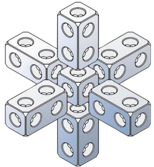
Sechs Seiten, acht Ecken, zwölf Kanten: Ausgangsform und Grundelement der ALUFIX-Systemgeometrie ist der Würfel. Alle weiteren Element-Konfigurationen entstehen durch Vervielfachung dieser Grundform – wobei durchgängige Bohrungen auf allen Flächen Anbindungsmöglichkeiten zu sämtlichen Seiten schaffen. Jede Bohrung ist sowohl zum Positionieren als auch Befestigen geeignet.
