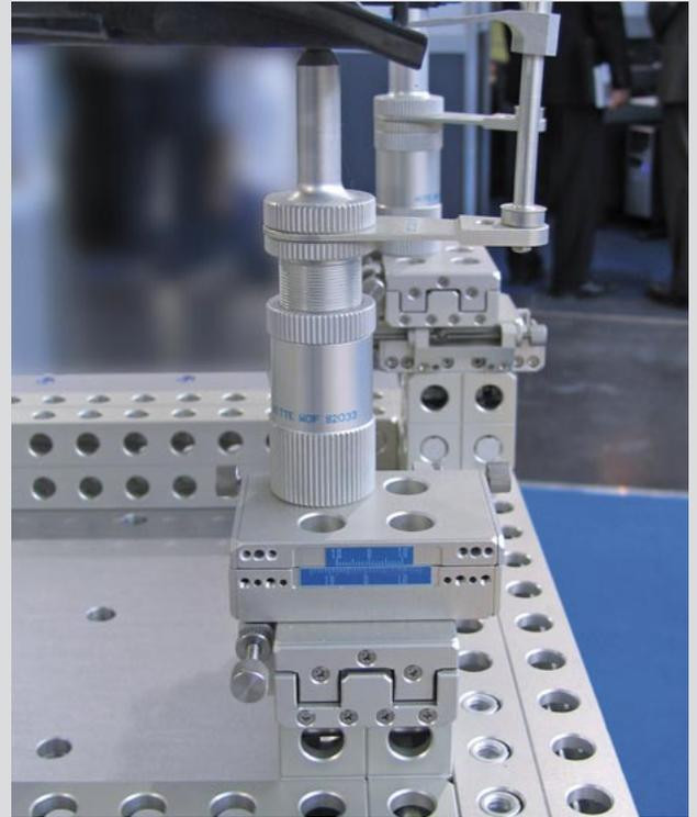
Oben: Der Kreuzrollenschlitten ermöglicht eine stufenlose Justage der Zentrierspitze in der x- und y-Achse – durch Anschlagsschrauben und Skalen mit Nonius präzise und reproduzierbar.
