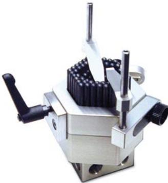
Die leicht beweglichen Nadeln passen sich der Form des Werkstücks an. Durch Arretieren des Adapters kann der „Abdruck“ des Werkstücks fixiert werden und ermöglicht somit reproduzierbare Werkstückfixierungen. Das Werkstück wird zusätzlich durch Niederhalterfedern von oben gehalten.
