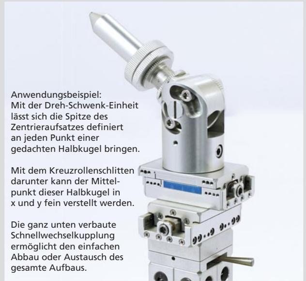
Anwendungsbeispiel: Mit der Dreh-Schwenk-Einheit lässt sich die Spitze des Zentriersaufsatzes definiert an jeden Punkt einer gedachten Halbkugel bringen.
