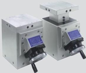
Anwendungsbeispiel rechts: Hubsäulen in Verbindung mit Kreuzrollschlitten, beide in HD-Ausführung, zum Positionieren von Hakenspannern in drei Achsen. Fußplatten mit Raster zum Befestigen auf Grund- oder Messplatten.
