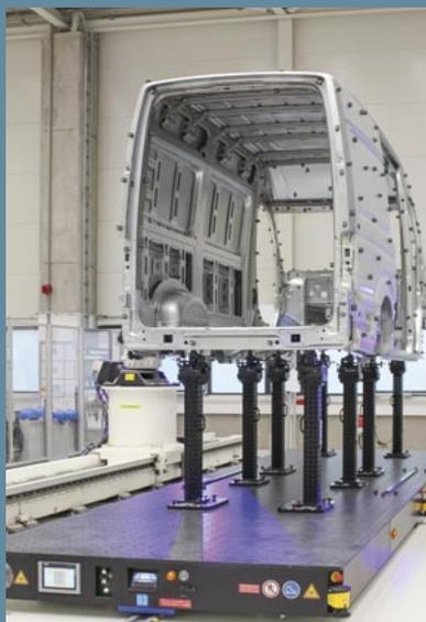
Als Basis für anspruchsvolle Aufgaben im Vorrichtungsbau in Säulenbauweise eignen sich Strukturplatten aus dem Witte FixBase® Programm optimal.
