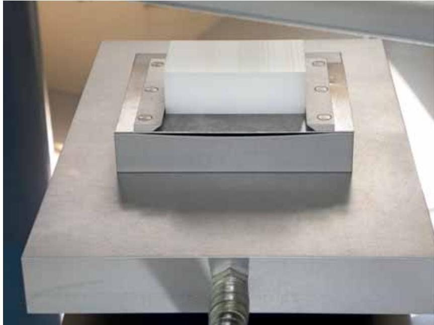
Wenn z.B. auf einem Fräszentrum mehrere aufeinanderfolgende Arbeitsschritte ein Umspannen des Werkstücks erfordern und Restflächen für eine direkte Vakuumspannung zu gering sind, kann diese innovative Spanntechnik zum Einsatz kommen.
