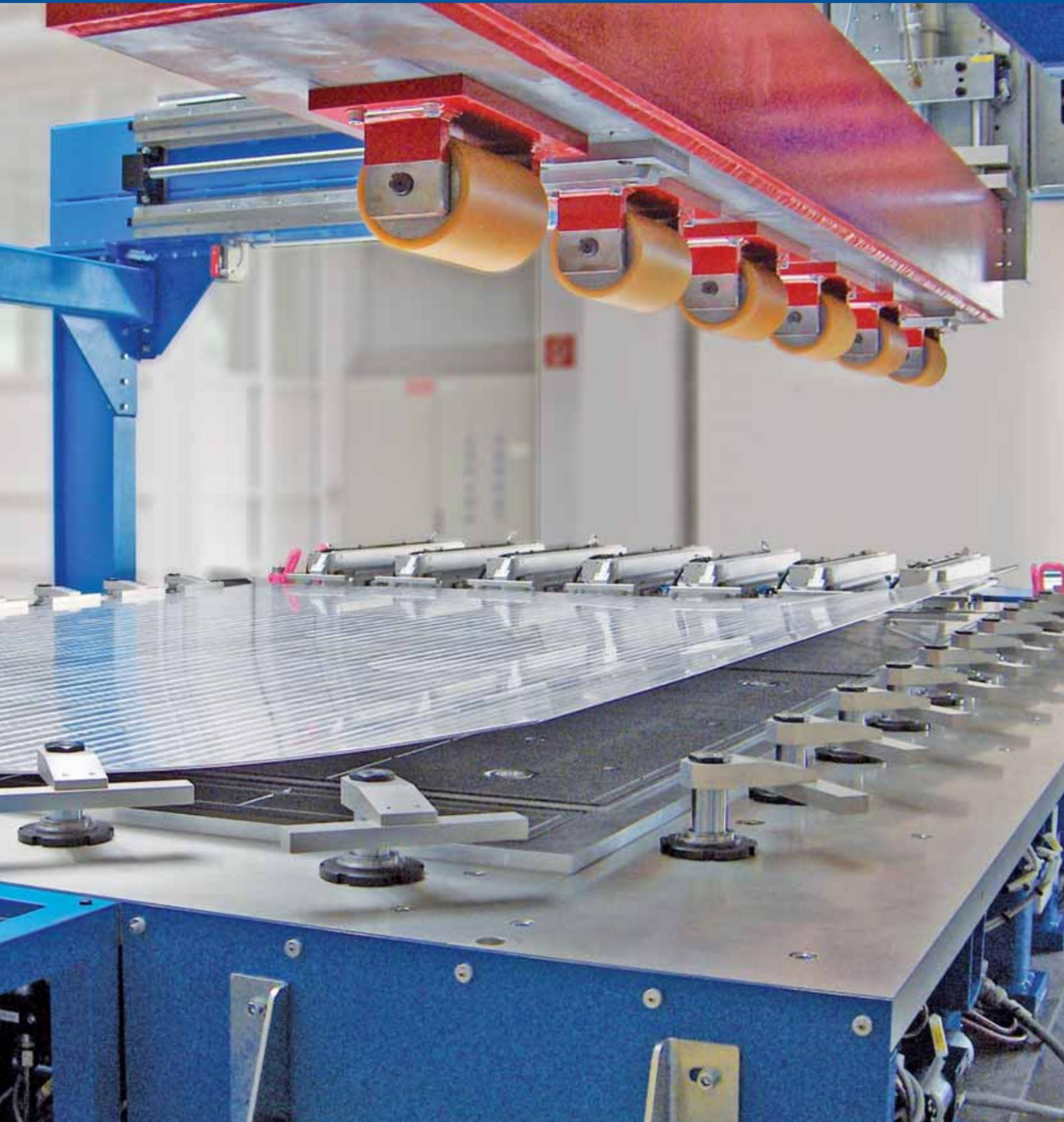
Vakuum - Spannsystem mit gesteuertem Druckbalken zur Unterstützung des Spannvorganges. Werkstückspannung von Aluminium- Hautfeldern für Luftfahrtgeräte.
