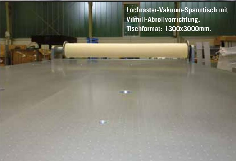
Lochraster-Vakuum-Spanntisch mit Vilmill-Abrollvorrichtung.
