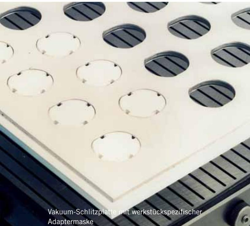
Vakuum-Schlitzplatte mit werkstückspezifischer Adaptermaske
