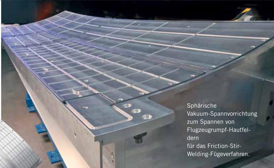
Sphärische Vakuum-Spannvorrichtung zum Spannen von Flugzeugrumpf-Hautfeldern für das Friction-Stir-Welding-Fügeverfahren.
