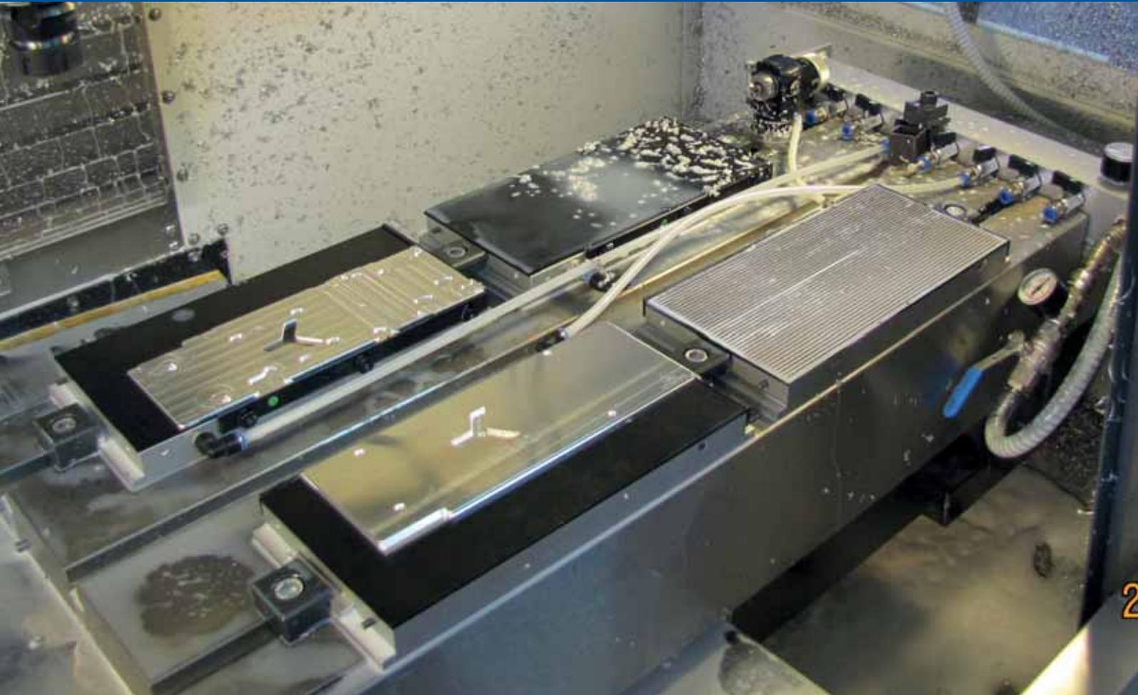
4 Schlitz-Vakuum-Spannplatten in der Produktion, bei der Herstellung von Aluminiumträgern.
