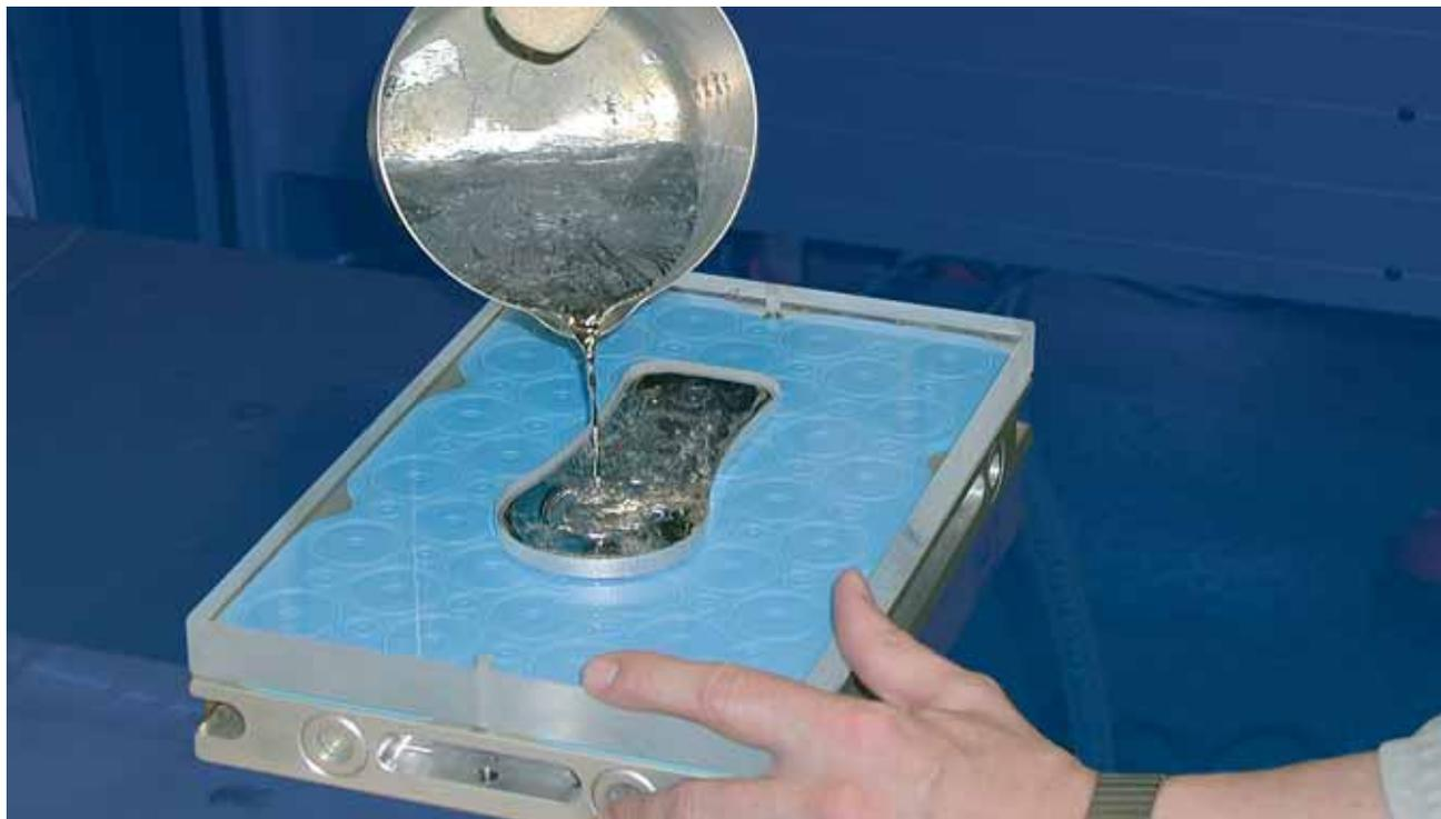
Die **Witte Weiguss Spanntechnik** eignet sich zum Herstellen von Werkstücken die sich aufgrund fehlender An- und Auflageflächen mit herkömmlichen Mitteln nicht spannen lassen.
