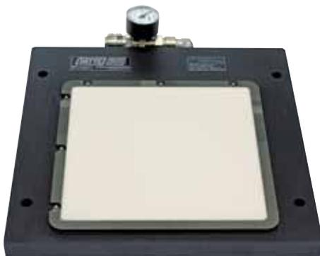
Feinstgefrästes Vakuum chuck zum Spannen von Wafern. Spannfläche aus mikroporösen Werkstoff Witte MP CE100 WHITE. Plangenauigkeit < 0,005mm
