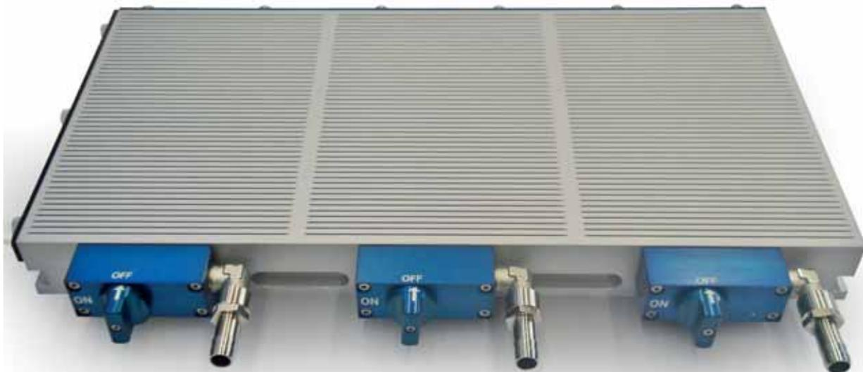
Schlitz-Vakuum-Spannplatte in einer 3-fach Ausführung
