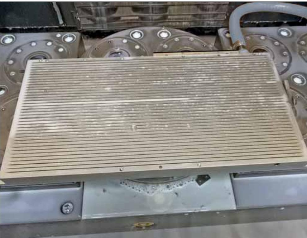
Schlitz-Vakuum-Spannplatte gespannt auf einem Nullpunktspannsystem.
