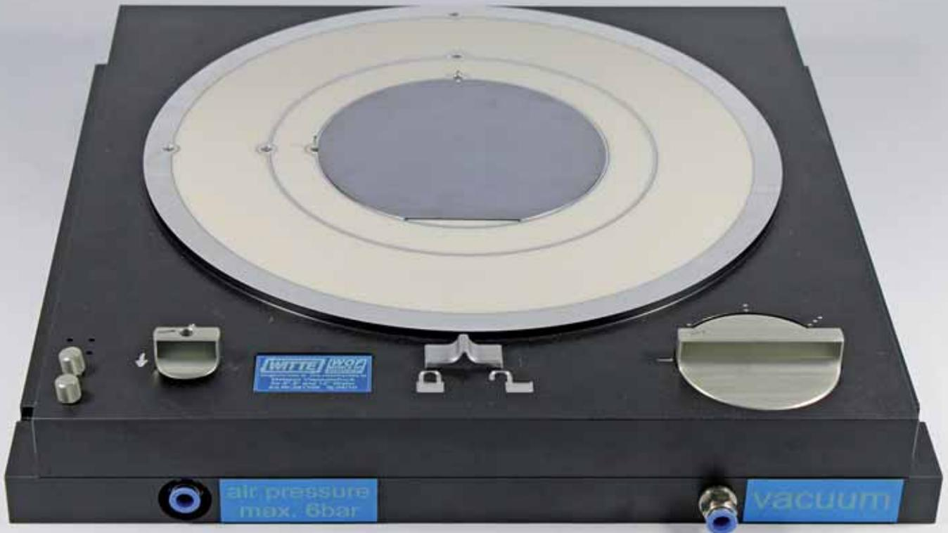
Sonderausführung mit drei gesteuerten Spannbereichen, Anschlägen für die Werkstückpositionierung und so genannten Liftingpins zur Erleichterung der Waferentnahme
