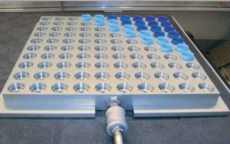
Vakuum- Spannplatte zum Spannen von Getränkerverschlüssen beim Messvorgang auf Koordinaten-Messmaschinen.
