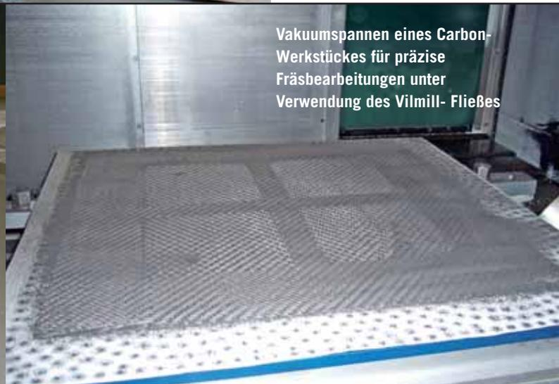
Vakuumspannen eines Carbon-Werkstückes für präzise Fräsbearbeitungen unter Verwendung des Vilmill- Fließes
