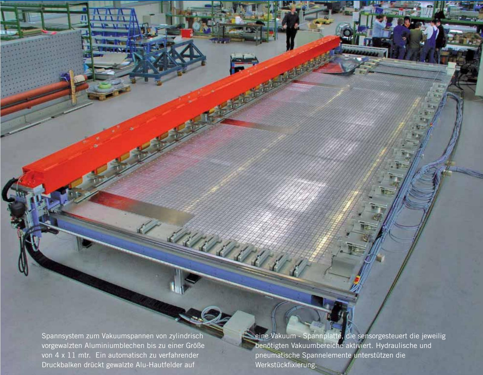
Spannsystem zum Vakuumspannen von zylindrisch vorgewalzten Aluminiumblechen bis zu einer Größe von 4 x 11 mtr. Ein automatisch zu verfahrenender Druckbalken drückt gewalzte Alu-Hautfelder auf
