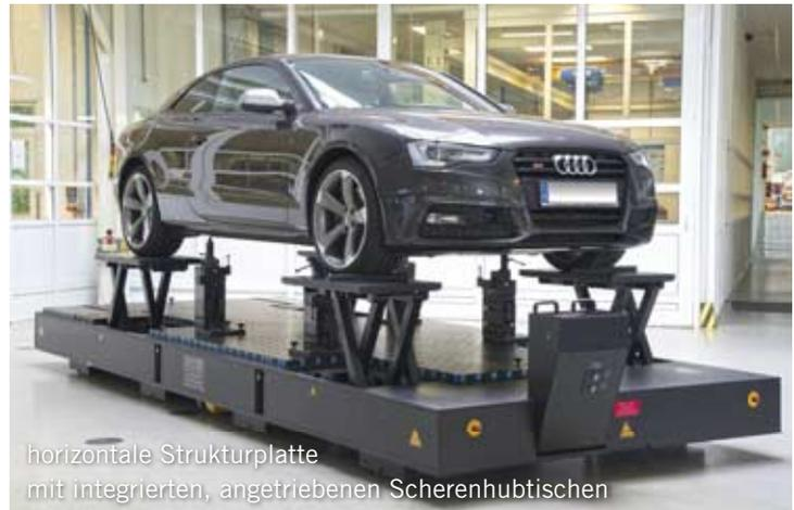
horizontale Strukturplatte mit integrierten, angetriebenen Scherenhubtischen
