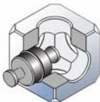
Schlossbolzen zum Positionieren
