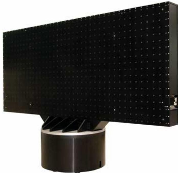
Vertikale Alu Strukturplatte auf luftgelagertem Drehteller
