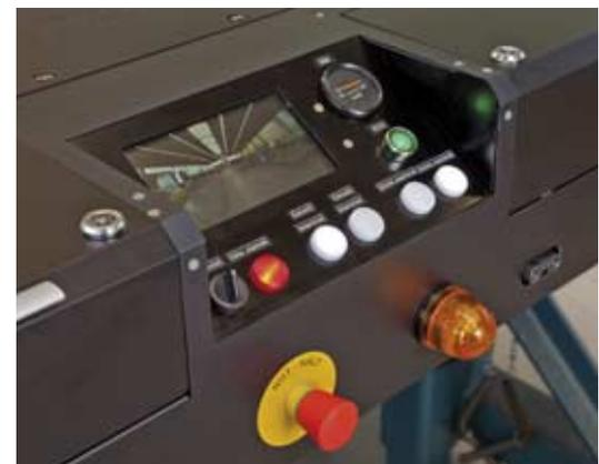
Bedienpult mit Fahrkamera-Monitor
